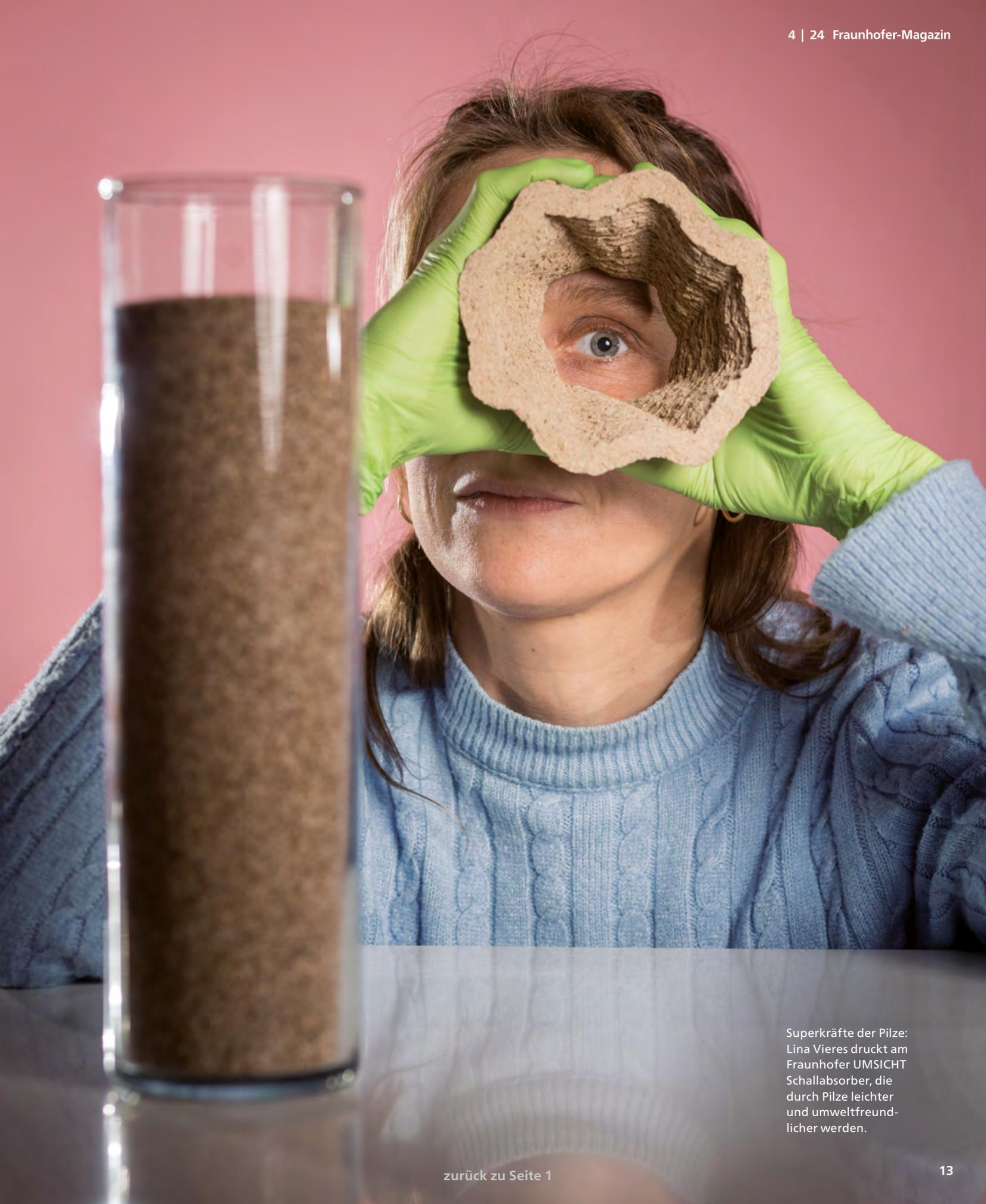
Superkräfte der Pilze: Lina Vieres drückt am Fraunhofer UMSICHT Schallabsorber, die durch Pilze leichter und umweltfreundlicher werden.
